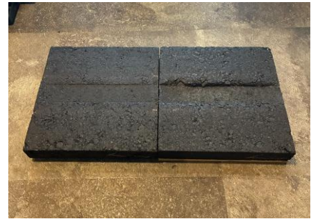
耐久性比較 (左:エコ・ループファルト、右:アスファルト混合物)
