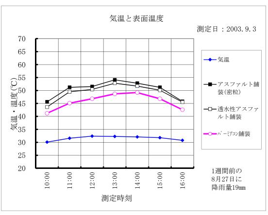
パーミアコンとアスファルト舗装の舗装表面温度比較例
