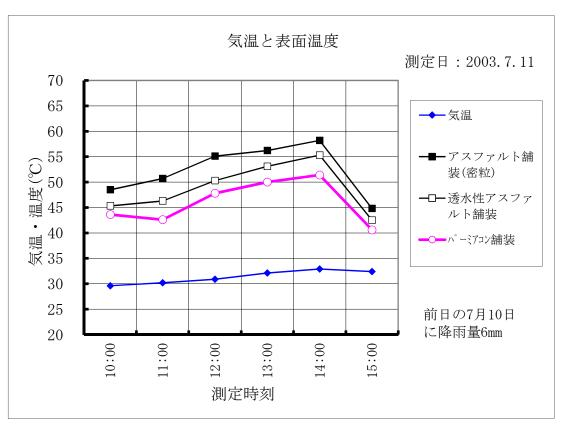
パーミアコンとアスファルト舗装の舗装表面温度比較例
