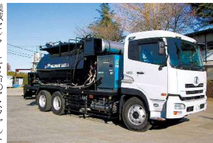
アスファルト注入車
